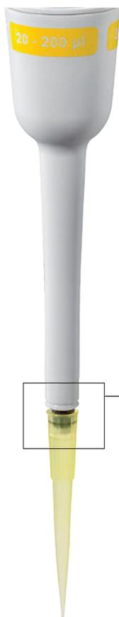
La Transferpette® electronic monocanal dans les plages de volume 10 à 200 µl et 50 à 1000 µl, dispose à titre d'accessoires d'une pointe de tige à 2 composants brevetée (dur / élastique) et de 3 clips interchangeables. Ils servent à réduire la force de fixation et d'éjection des pointes de pipettes.
